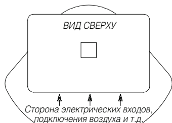
РИСУНОК 1. Среднее положение квадрата привода и корпуса позиционера
